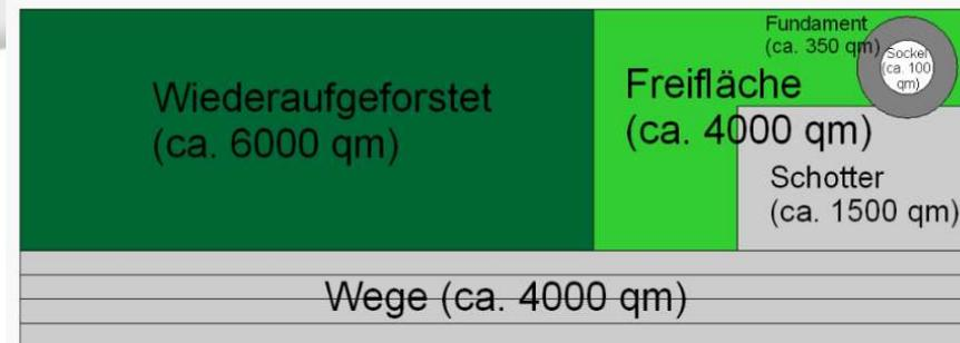
Abbildung 1: durchschnittlicher Flächenbedarf einer Windenergieanlage
