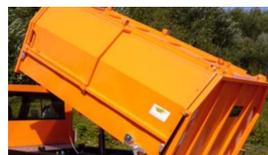
**kippbarer Müllsammelau-fbau mit seitlichen Türen und hinterer Klappe**
